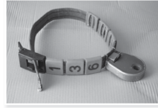
الشكل (٣-٥): جهاز التغذية الإلكتروني.
