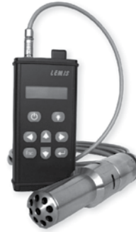
الشكل (٣-٢): جهاز قياس لزوجة الحليب.
