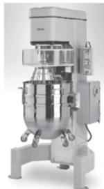
الشكل (٣-١): شكل من أشكال الخلاطات.
